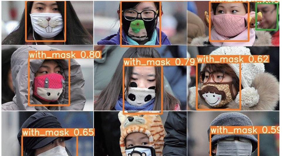
圖 16 不同造型口罩影像測試結果
